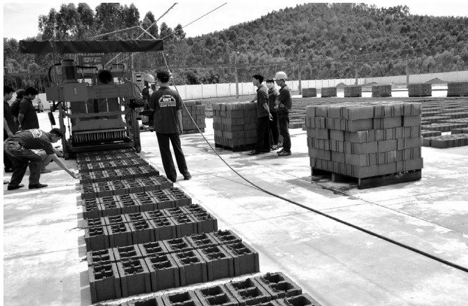
Sản xuất gạch không nung tại Công ty TNHH Sản xuất Thương mại GMT tại xã Nhơn Tân. Ảnh: Tư liệu
